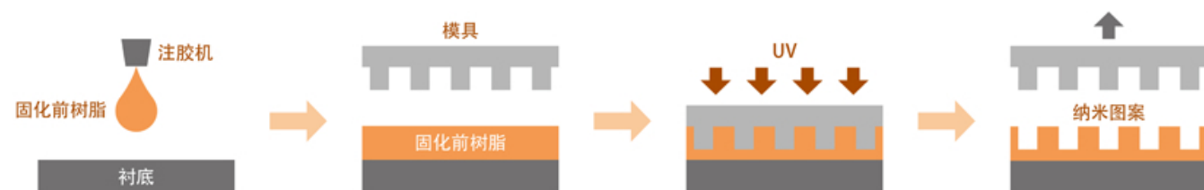
■ UV纳米压印制程概况图
